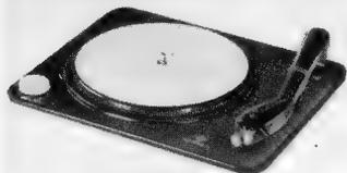
entwickelt (Bild). Durch die minimale Auflagekraft konnte die Beanspruchung der Platte stark herabgesetzt werden. Der Antrieb erfolgt durch einen vierpoligen Motor mit geringer Drehzahl, dessen neuartige federnde Lagerung Erschütterungen und Rumpelgeräusche ausschließt. Hersteller: Electroacoustic GmbH, Kiel.
