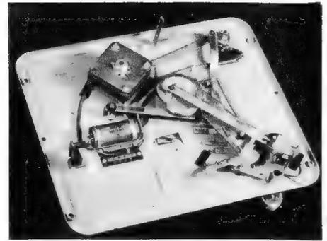
Bild 4. Der einfache Mechanismus des Dokamix-Plattenwechslers von Wumo
