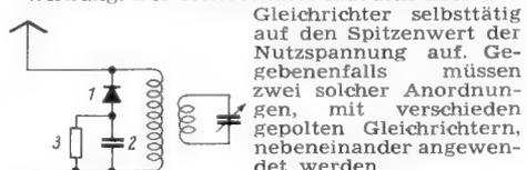
Gleichrichter selbsttätig auf den Spitzenwert der Nutzspannung auf. Gegebenenfalls müssen zwei solcher Anordnungen, mit verschieden gepolten Gleichrichtern, nebeneinander angewendet werden.
